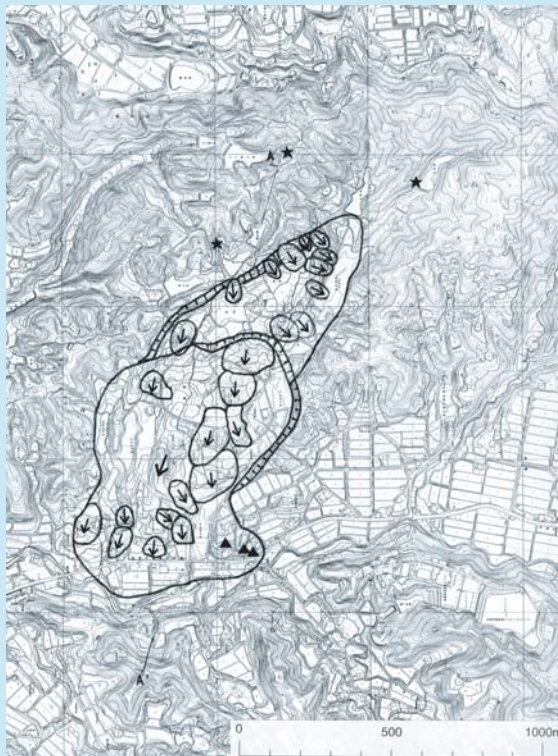
地すべりブロック図 (★印: 凝灰岩の貫入を確認)
