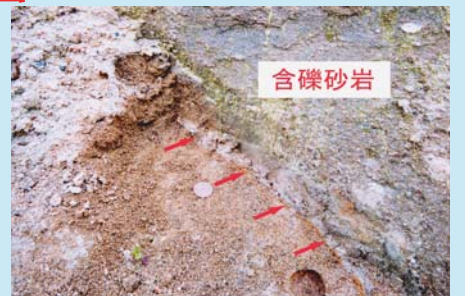
写真-8 含礫砂岩ブロックと破砕部の境界に凝灰岩が貫入
