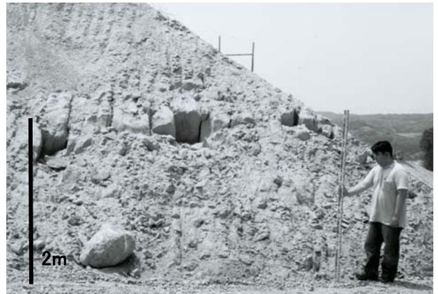
図-5 鉛直方向に発達する鉛直亀裂
